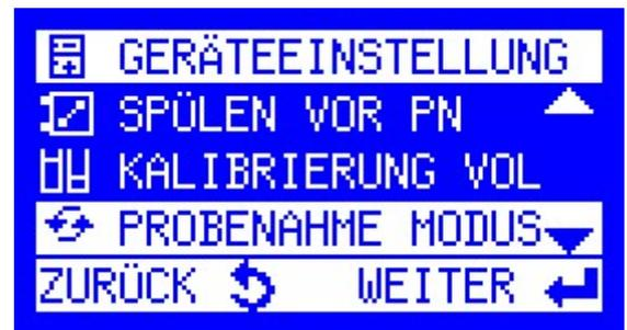
„**STANDARD**“: das Probenvolumen wird durch die die beiden Sensoren ermittelt. Das System muss dazu vorher kalibriert werden (idealerweise an der Messtelle).
