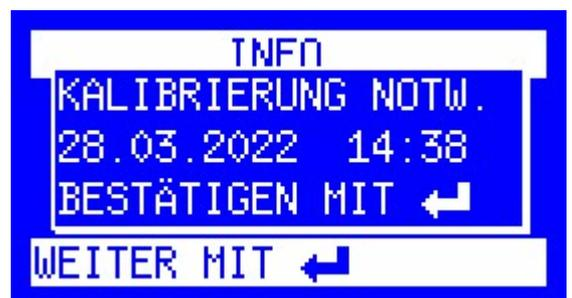
**Hinweis:** nach dem Laden der „**Factorysettings**“, muss die Schlauchpumpe wieder neu kalibriert werden! Bitte beachten Sie, dass der **Probenahme-Modus** dann auch wieder auf „**STANDARD**“ eingestellt ist.
