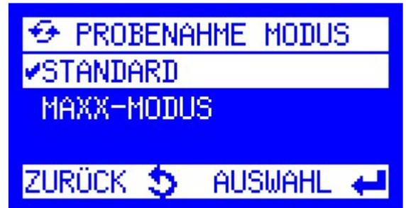
„**MAXX-Modus**“: Diese Funktion ermöglicht nun eine Probenahme in **Abhängigkeit vom Sensorstatus**. Wenn einer der Sensoren durch Verschmutzung im Schlauch, das Wasser (Medium) nicht mehr richtig detektiert, wird automatisch auf diesen Modus umgeschaltet und „fehlende“ Werte der Sensoren durch vorhandene, gespeicherte ersetzt. Eine Kalibrierung muss auch hier vorher erfolgt sein (idealerweise auch an der Messtelle).
