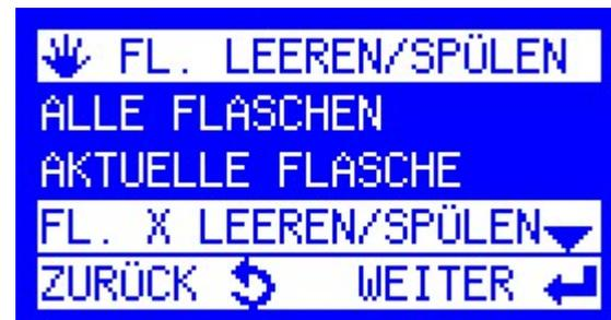
Bei jeder Flasche die schon befüllt wurde, wird Datum mit Uhrzeit angezeigt von wann bis wann sie befüllt wurde. Damit können sie sofort erkennen, in welcher der Flaschen sich z.B. eine Ereignisprobe befindet. Ein versehentliches Entleeren/Spülen der „falschen“ Flasche kann damit besser verhindert werden.
