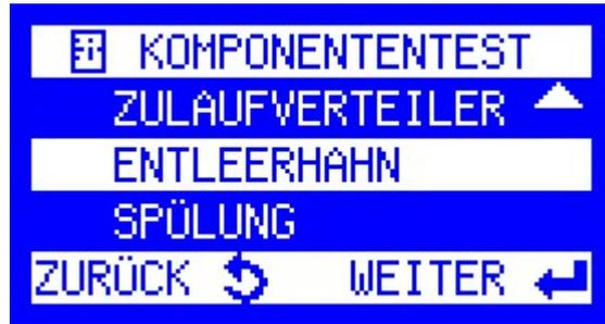
Drücken sie die Pfeiltaste ◀ wird er eingeschaltet. Es handelt sich um einen Exzenterantrieb, der nur in eine Richtung läuft. Das Ventil wird zuerst geöffnet und dann wieder geschlossen
