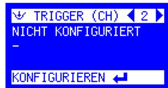
Jetzt muss der EINGANG KANAL 2 gewählt werden um den Grenzwert für diesen Kanal zu konfigurieren. Für den Grenzwert Kanal 2 ist hier **Leitfähigkeit (Lf)** ausgewählt.
