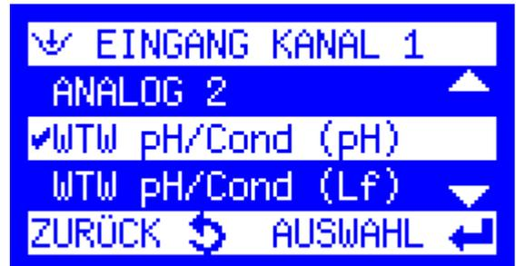
Nach Auswahl des Parameters für Kanal 1, muss ein unterer „LOW SETPOINT“ oder oberer „HIGH SETPOINT“ Grenzwert eingestellt werden. Die Überwachung des Kanals kann aber auch deaktiviert werden („KEINE ÜBERWACHUNG“)
