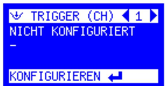
Im nächsten Schritt muss in EINGANG KANAL 1 einer der zur Verfügung stehenden Parameter zum Konfigurieren ausgewählt werden (z.B. pH-Wert)
