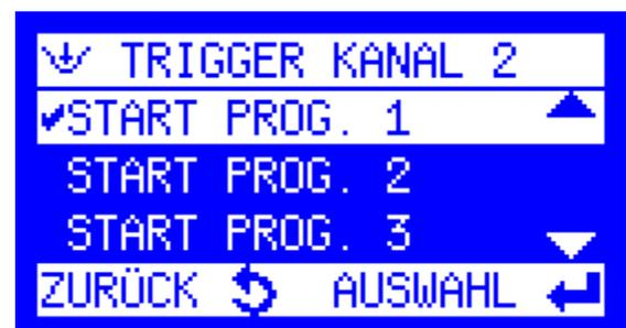
Wenn der Trigger für Kanal 2 konfiguriert ist (**TRIGGER(CH) 2**), erscheint im Menü direkt wieder der real gemessene Wert für Leitfähigkeit (**mS/cm**) der angeschlossenen Sonde.
